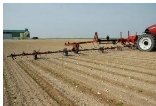
Rampe de traitement localisé (©ITB)
